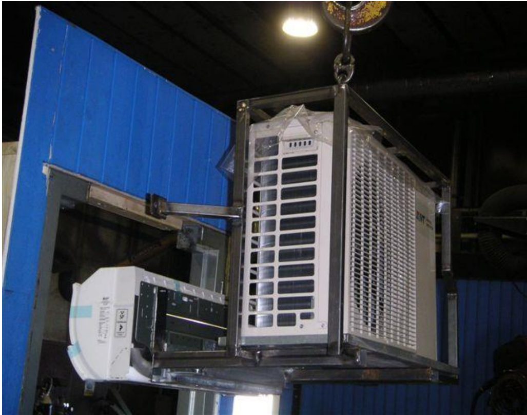
Bild 2. Montagealternativ 2 ovanför dörr på långsida.
